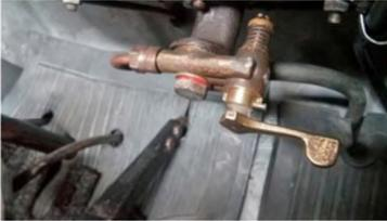
An den Ur-Topolinos und den entsprechenden Simca cinq Modellen ist der Kraftstoffauslauf unten am Tank. Der **Kraftstoffbehälter-Hahn** hat drei **Positionen**: ZU, AUF und RESERVE. Es gab keine Anzeige für den Benzinstand im Tank. Geht am 500 (A) das Benzin zur Neige, kann der Kraftstoffbehälterhahn auf RESERVE umgestellt werden. Dann sind noch 3 bis 4 Liter im Tank,
